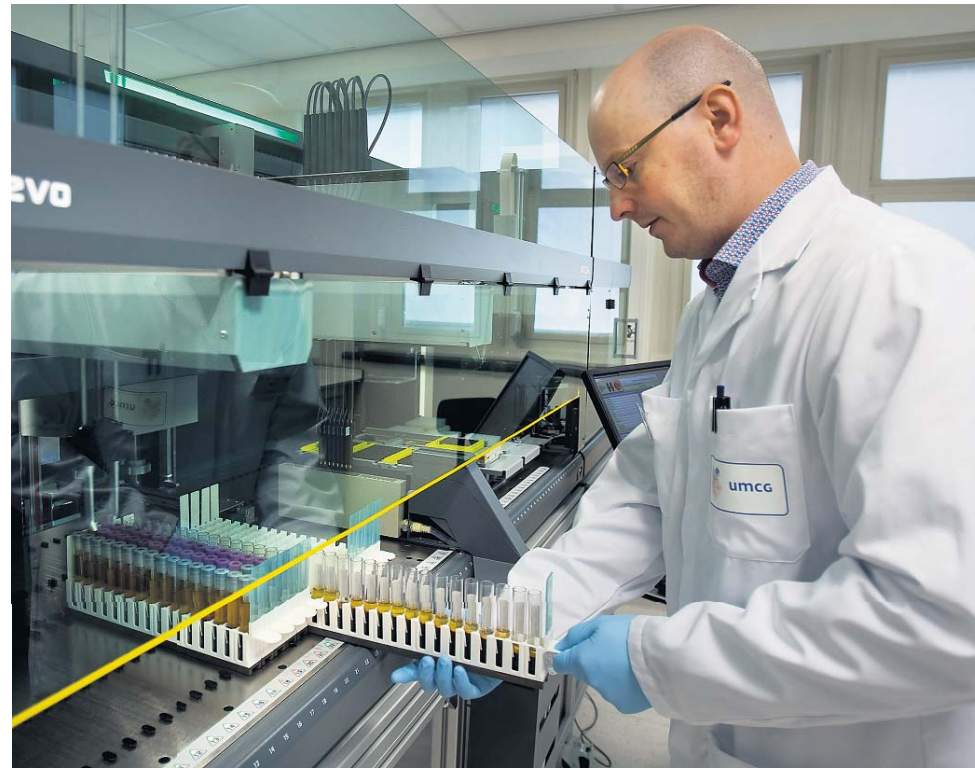
4 Bloed- en urinemonsters worden door een robot verdeeld in tientallen kleine cupjes, die geordend en gecodeerd in enorme vrieskisten gaan.
